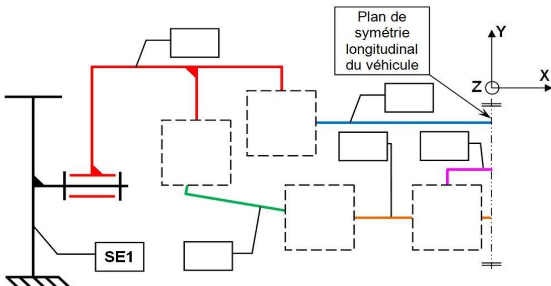
**2.8)** Connaissant la vitesse de déplacement de la roue extérieure lors du braquage, déterminer à l'aide du centre instantané de rotation la vitesse de déplacement de la roue intérieure, les tracés seront effectués sur la silhouette du véhicule ci-dessous :
