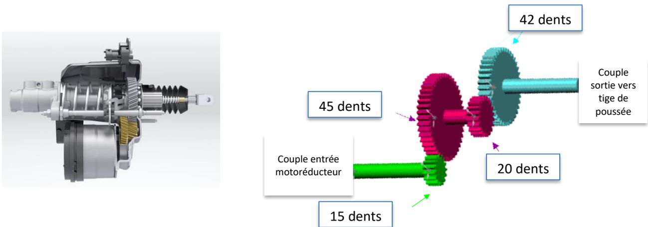
**3.7)** Déterminer en N la force de poussée fournie par l'ensemble « arbre fileté + chariot » pour établir dans le circuit hydraulique une pression de 6MPa.
