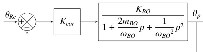
**Figure 11** - Schéma bloc simplifié avec correcteur proportionnel
