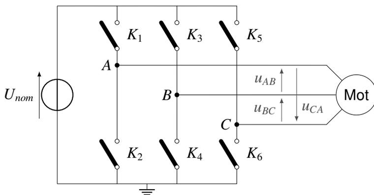
Figure 15 - Schéma électrique de la motorisation
