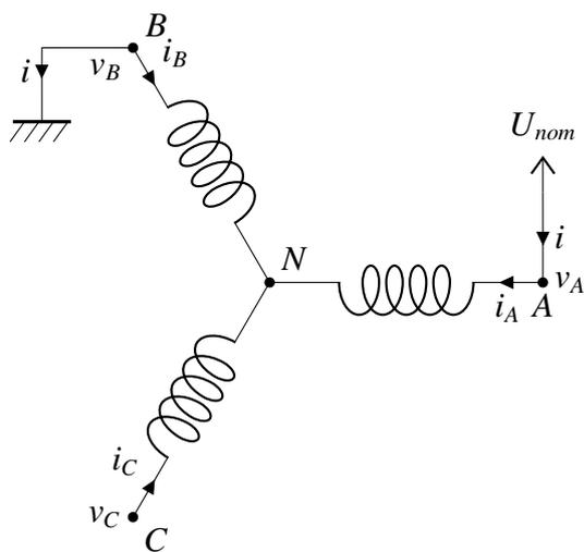
**Figure 17** - Modèle électrique du moteur brushless
