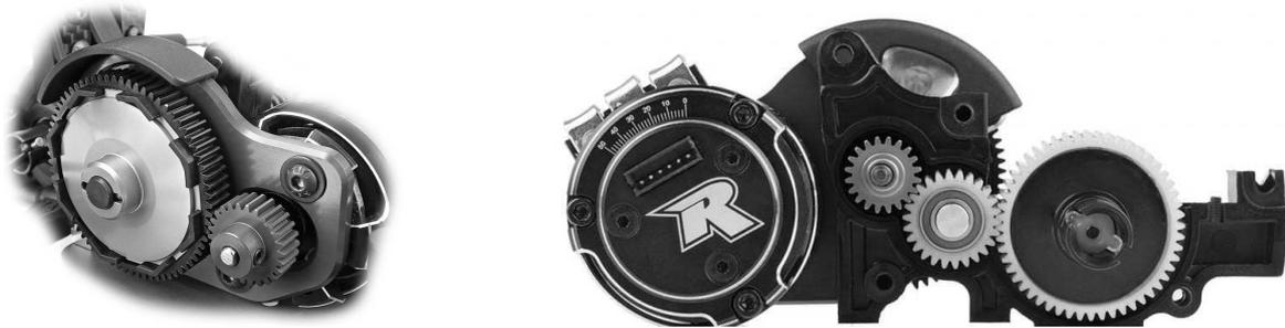
**Figure 20** - Boîtier de transmission
