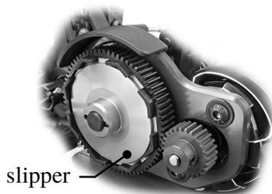
**Figure 22** - " slipper " monté sur la boîte de transmission
