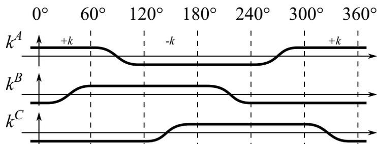
**Figure 19** - Constantes de vitesse en fonction de l'angle du rotor
