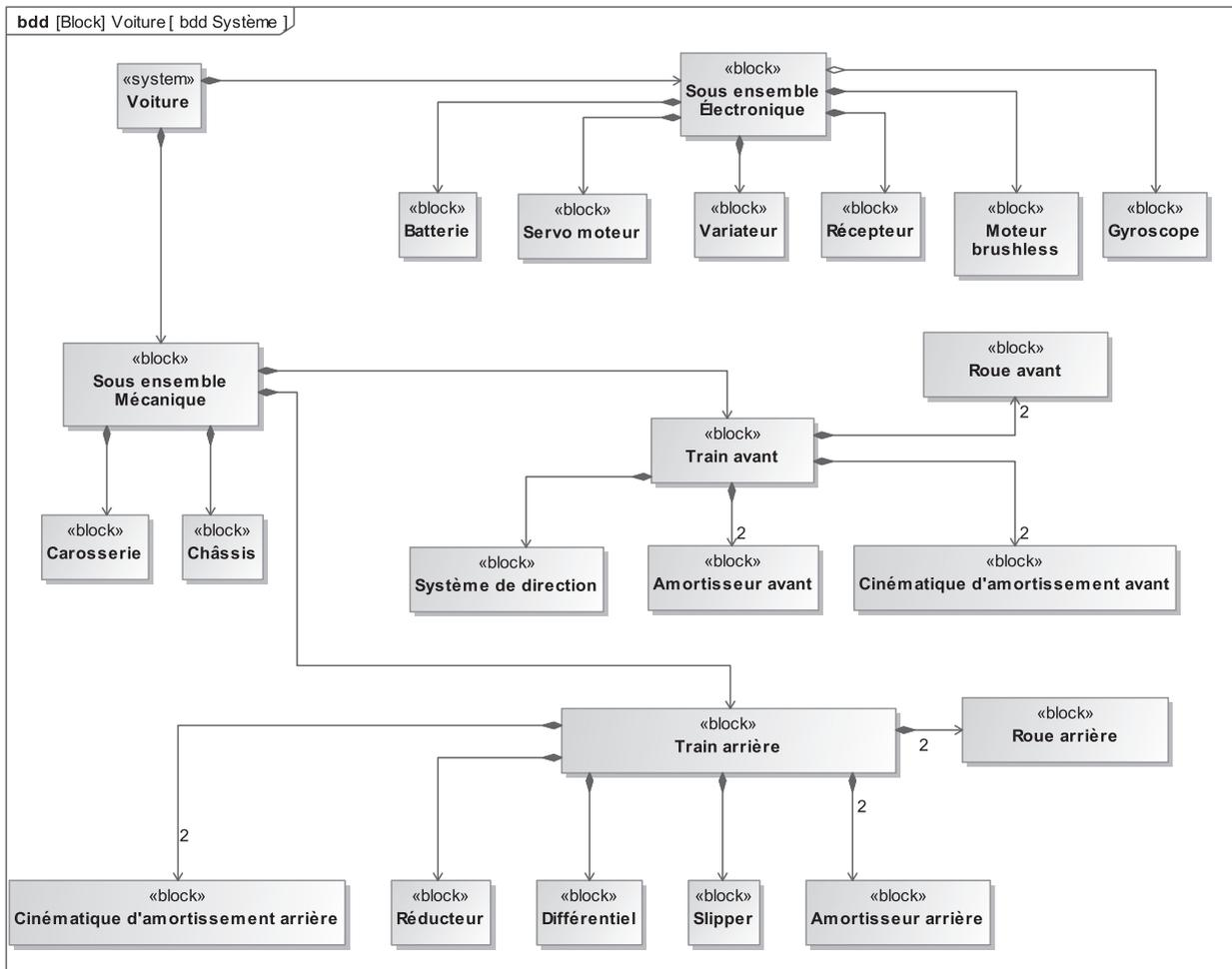
Figure 36 - Diagramme de définition de bloc du système
