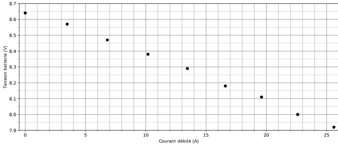
Figure 14 - Caractéristique tension/courant de la batterie
