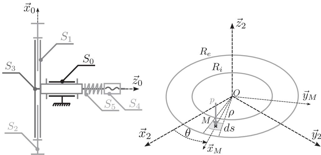
**Figure 24** - Schéma cinématique du " slipper " monté sur la boîte de transmission
