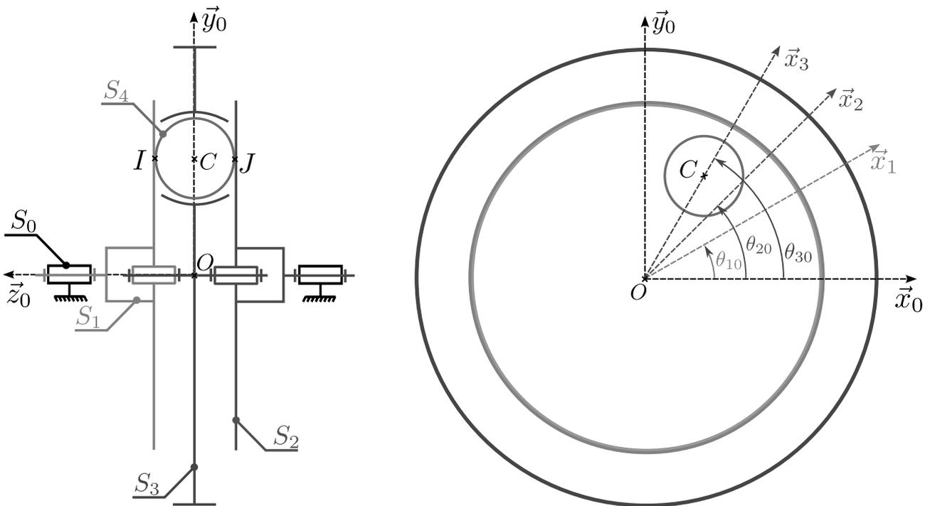
Figure 27 - Schéma cinématique simplifié du différentiel
