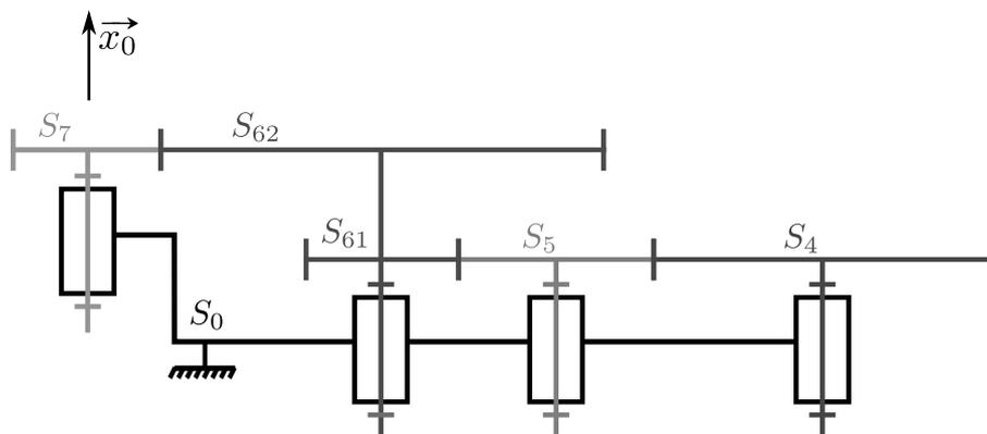
**Figure 21** - Schéma cinématique du boîtier
