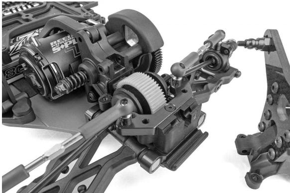
Figure 25 - Différentiel monté dans la voiture
