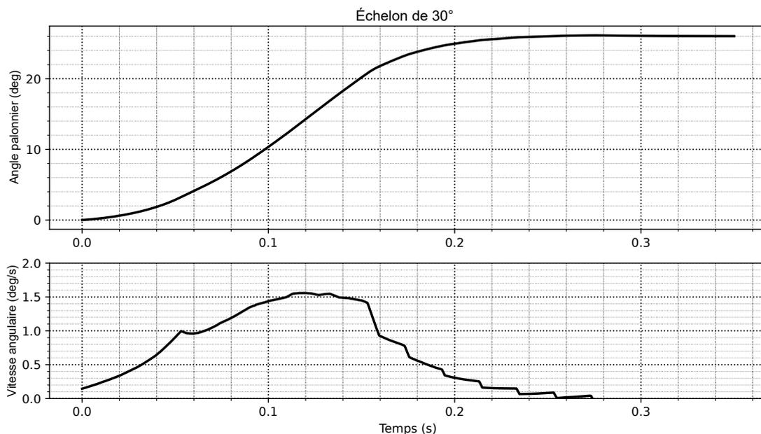
**Figure 10** - Évolution de l'angle et de la vitesse angulaire du palonnier pour une variation de consigne en échelon de  $30^\circ$
