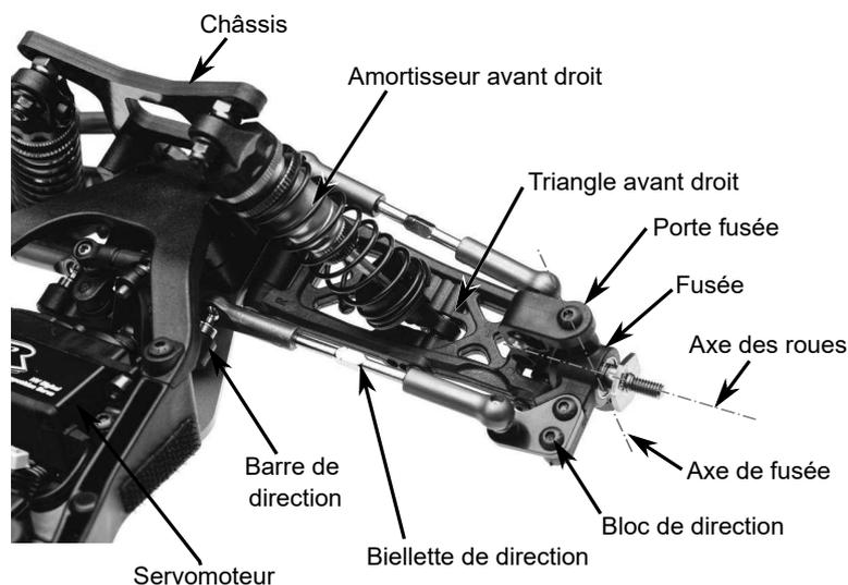
**Figure 4** - Éléments constitutifs de la direction d'une voiture radiocommandée
