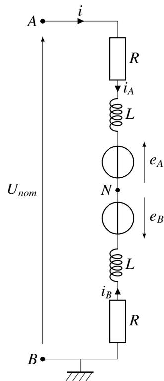
**Figure 18** - Modèle électrique du moteur brushless équivalent
