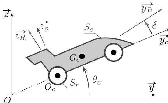
**Figure 31** - Schéma paramétré pour l'étude du vol du buggy
