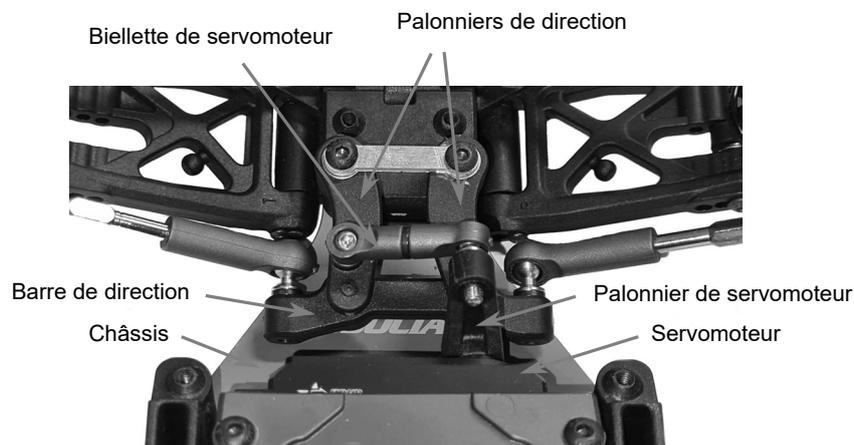
**Figure 5** - Détail des éléments de direction autour du servomoteur
