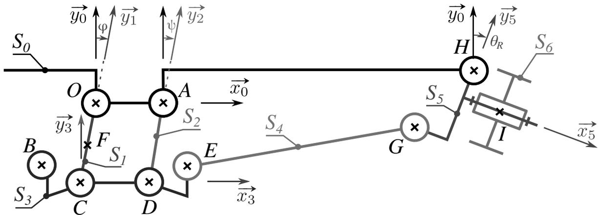
**Figure 6** - Schéma cinématique de la direction sans palonnier de servomoteur
