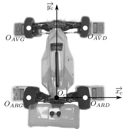
**Figure 29** - Balances placées sous les roues du buggy
