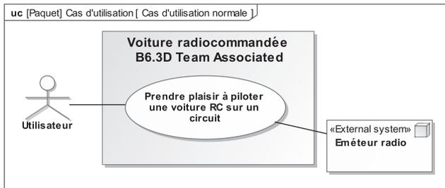
Figure 34 - Diagramme des cas d'utilisation
