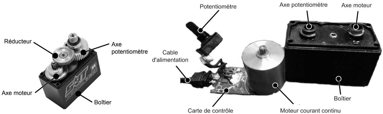
**Figure 8** - Réducteur du servomoteur
