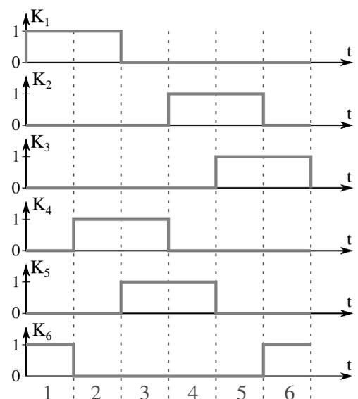
Figure 16 - Chronogramme de commutation des interrupteurs électroniques
