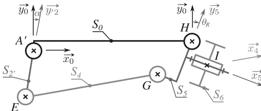
**Figure 7** - Schéma cinématique simplifié de la direction. Détail autour de la fusée et de la biellette de direction
