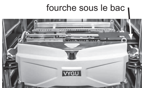
Figure 5 - Prise d'un bac (fourche sous le bac dans un rack)
