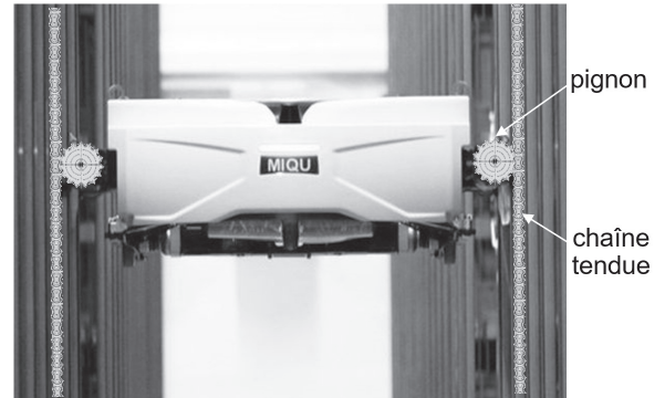
Figure 13 - Vue du robot en montée (sans charge ni bac), avec pignons et chaînes redessinés
