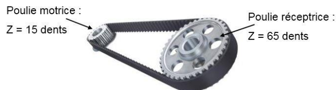
Figure 4 : Caractéristiques du système poulies / courroie
