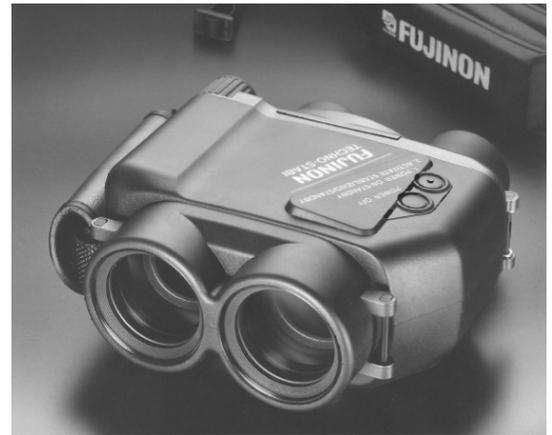
L'innovation technologique consiste dans le fait que les prismes sont sur des supports mobiles, déplaçables à très haute vitesse par deux servomoteurs, l'un assurant la compensation horizontale (AZ) et l'autre la compensation verticale (EL). Chacun de ces moteurs est contrôlé numériquement par l'association de capteurs de vibrations et de position.
