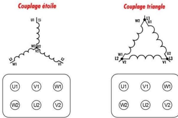
30- Donner les tensions aux bornes d'un enroulement en fonction du couplage réalisé pour un réseau triphasé 400 V.
