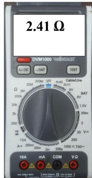
...**Les dégivreurs sont bons car la résistance doit être comprise entre 2.37 et 2.45 ohms**.....
