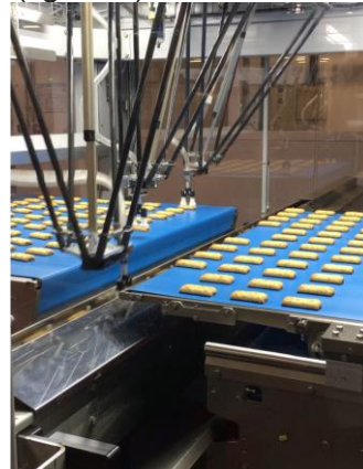
Figure 4 – Ramassage robotisé par préhenseur
