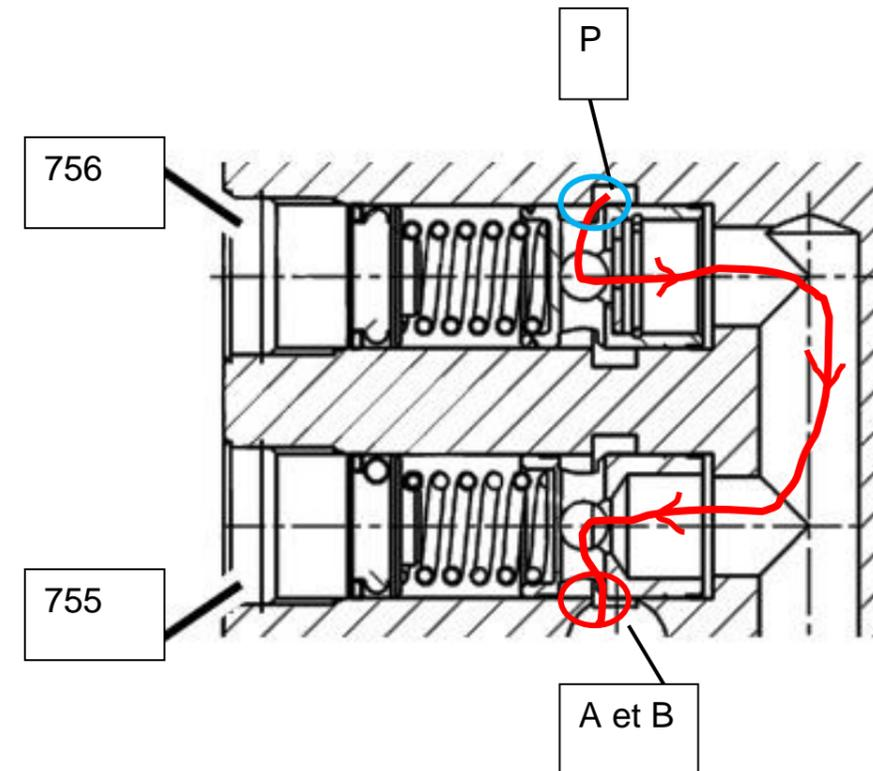
C16-1 : Lors de la commande montée de porte, montrer par un trait rouge orienté par des flèches le sens de circulation de l'huile.
