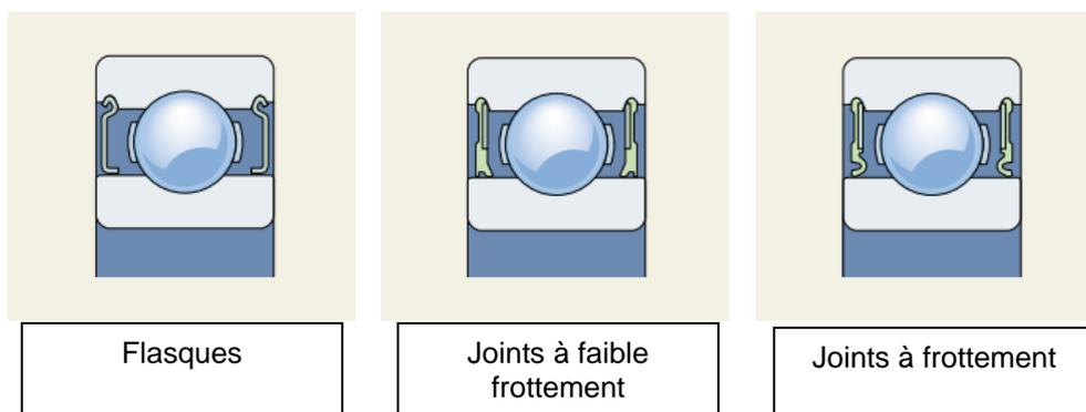
En fonction des dimensions et des séries, les roulements peuvent être munis :
