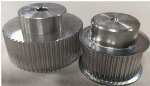
**Figure 7** : Système de poulie crantée
