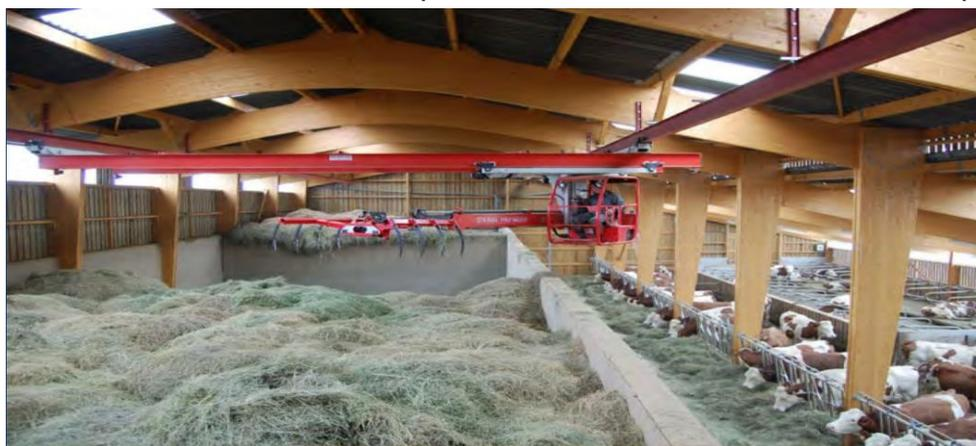
Sécher le foin en grange, consiste donc à ventiler ce foin avec de l'air ambiant. Mais lorsque l'humidité de l'air est trop importante, il devient indispensable de réchauffer l'air, avant de le ventiler, afin d'augmenter son pouvoir évaporatoire.
