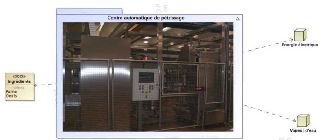
En entrée de chacune de ces lignes, un centre de pétrissage automatique est installé pour permettre la préparation en temps masqué des recettes prédéfinies par la production. Ce centre de pétrissage est constitué de quatre postes de travail automatisés. Le transfert d'un poste à un autre est réalisé par un robot de transfert cartésien (voir DP2).
