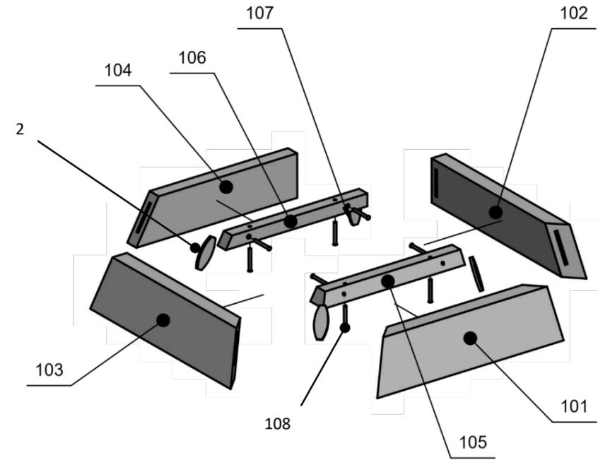
Les côtés sont assemblés avec des lamelles de bois Rep. 2 de type « Lamello ».
