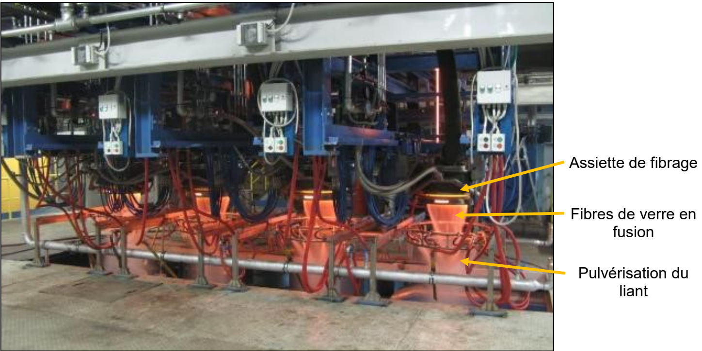
Étape 4 : Opération de fibrage des fils de verre.
