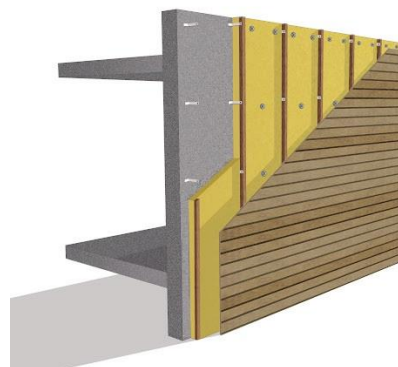
Figure 4.1 : exemple de mur isolé par l'extérieur
