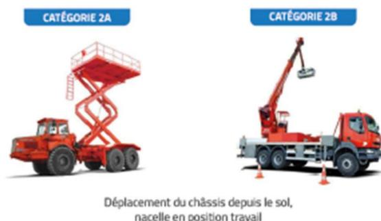
**PEMP : Type 2, A et B, PEMP sur châssis porteur (pas de stabilisateurs).**
