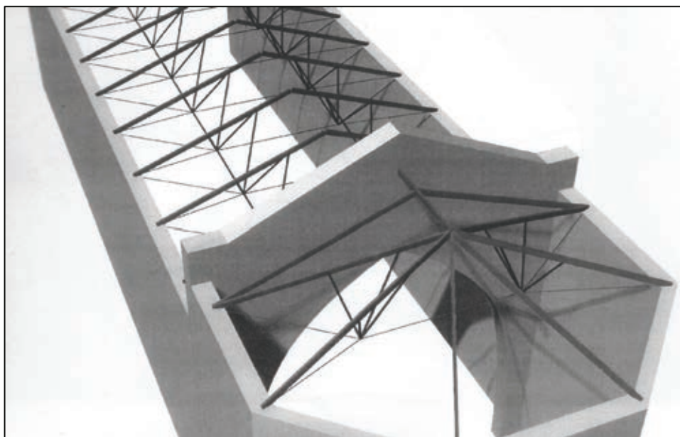
Figure 2 : principe de la charpente proposée
