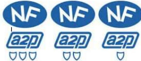
**Alarme NF a2p 1 Bouclier** : Le premier niveau de la norme va être destiné à des particuliers possédant, par exemple, un appartement en étage et dont la volonté est de sécuriser simplement la porte(s) d'entrée. Ce type d'alarme est recommandé pour des lieux où ne se trouve pas des objets de valeurs.
