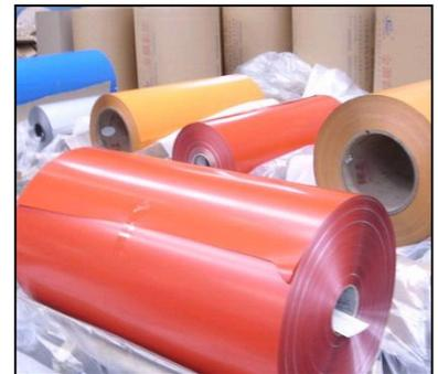
Les peintures utilisées pour le coil coating sont hydrosolubles et la polymérisation est assurée par des lampes Ultraviolet.
