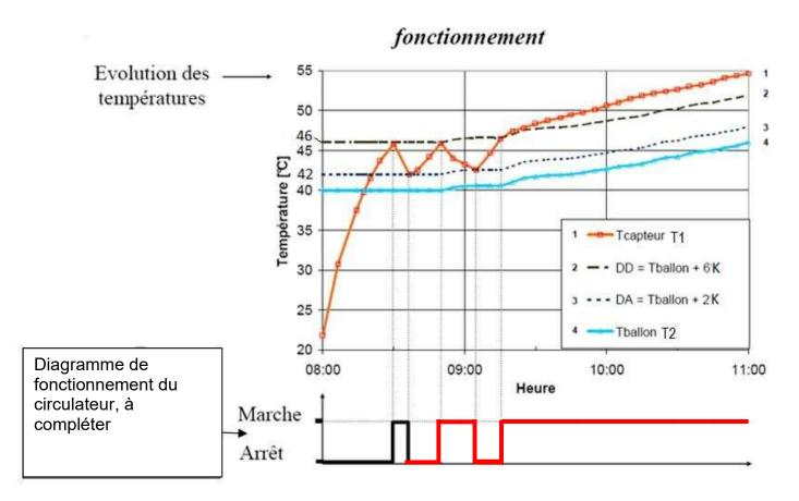
La valeur calculée ∆T est alors comparée aux différentiels d'arrêt et de démarrage.
