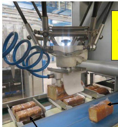
**Photo :** Robot Delta (4) équipé de ventouses permettant la préhension des sachets de biscottes afin de les déposer sur le tapis amont de l'étuyeuse
