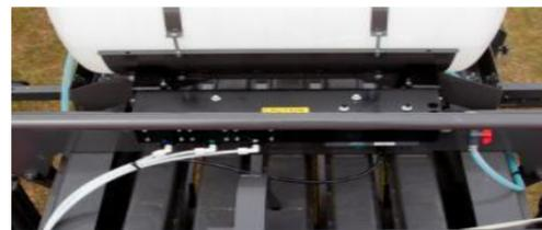
Maintenir les tuyaux éloignés des pièces en mouvement et des conduites hydrauliques dans lesquelles la température monte à plus de 60°.
