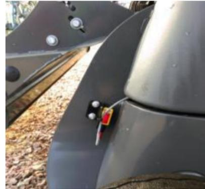
Monter l'émetteur (couleur verte) côté droit et le récepteur (couleur rouge) côté gauche en fixant à l'aide des 2 vis TRCC de 5/16 x 3/4, tête plate à l'intérieur.
