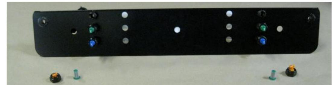
Dévisser les écrous de buses à l'aide d'une clé 7/8 de pouces. Empêcher le porte buse de tourner pendant l'opération avec une clé de 17 mm.
