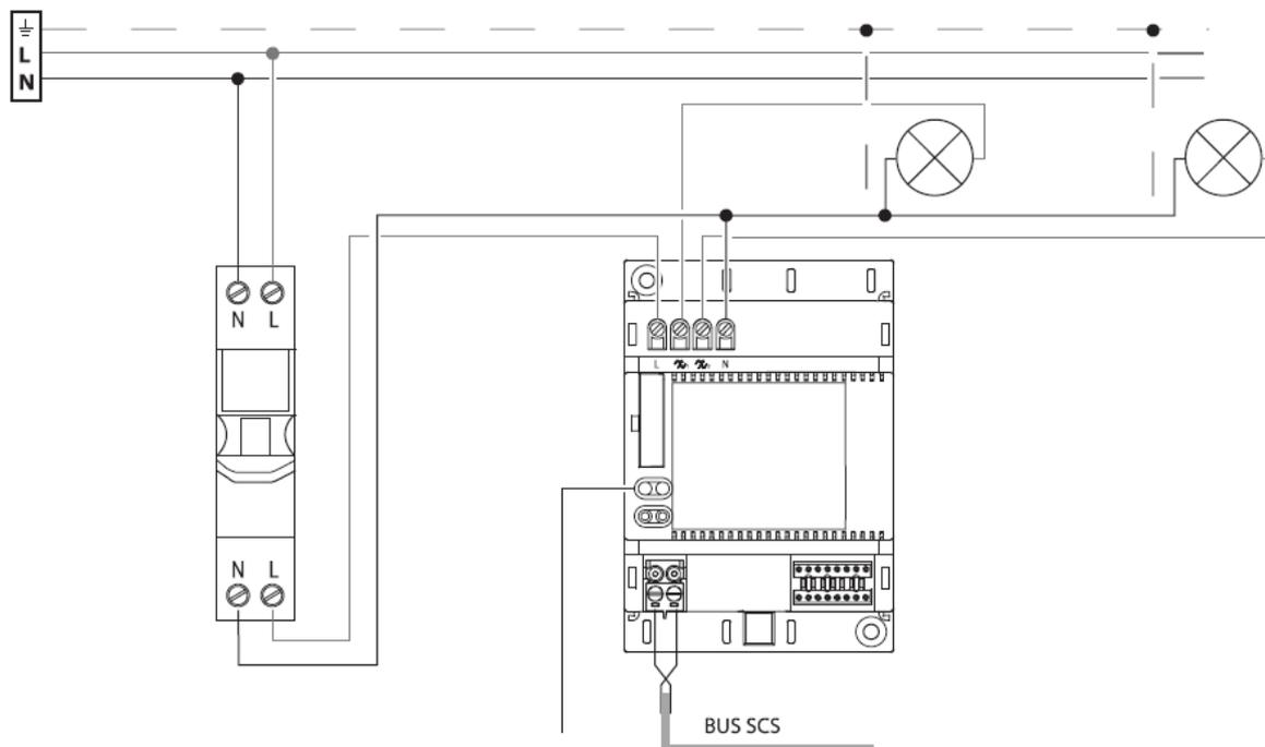
Schéma de connexion pour la configuration en modalité parallèle
