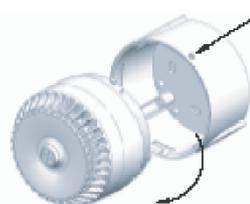
Vis de fermeture. Ne pas serrer trop fort Pour fermer, veuillez tourner dans le sens des aiguilles d'une montre
