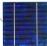
Le PW1650 est fabriqué à partir de 8 X 9 cellules polycristallines 5 pouces (125,50 mm X 125, 50mm) à haut rendement (jusqu'à 15%), avec une couche anti-reflet en nitrure de silicium.
