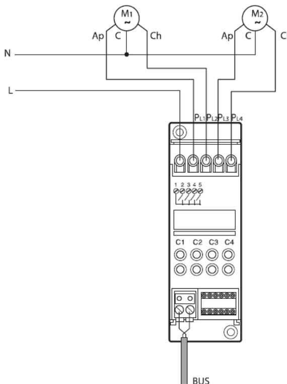
M1 = moteur qui commande le vantail avec butée intérieure
