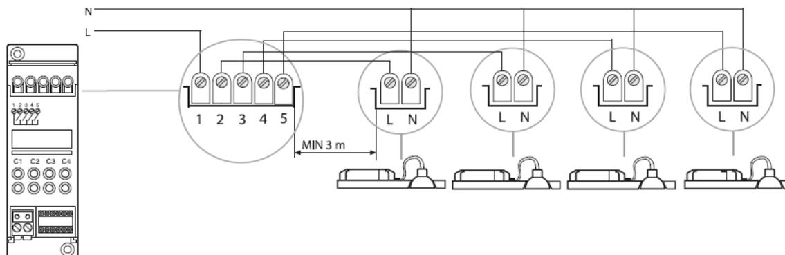
Schéma de commande pour la motorisation des volets persiennés
