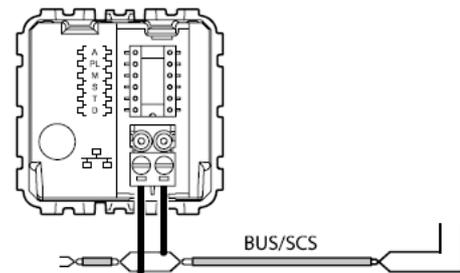
Un appui sur la commande auxiliaire permet d'allumer ou d'éteindre manuellement la charge. Si aucune action n'est effectuée sur la commande, le détecteur coupera sa charge en fin de temporisation ou lorsque le seuil de luminosité sera atteint.
