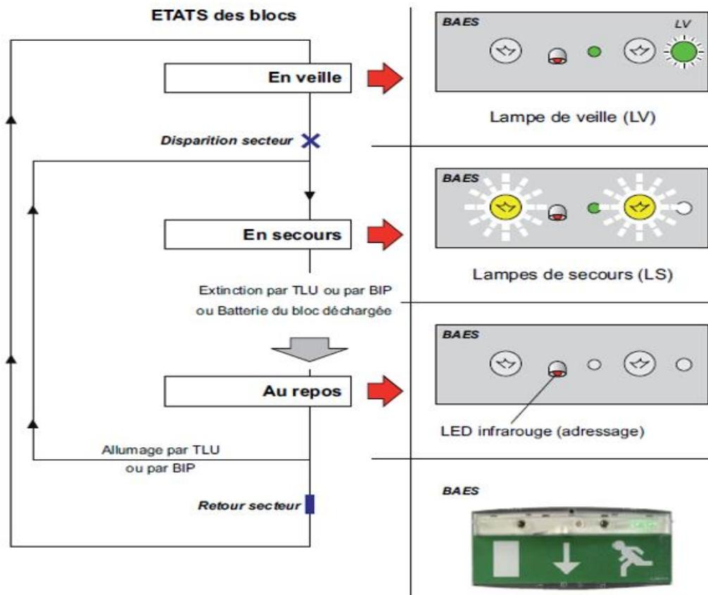
Schéma de principe d'un BAES :
