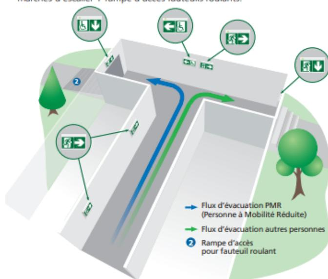
Exemple 2 : Couloir en T en étage avec sortie vers escalier à droite et espace d'attente sécurisé à gauche.
