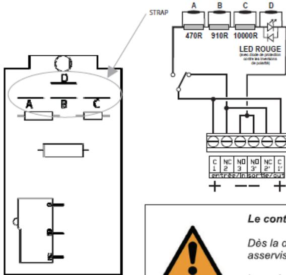
Les straps ne doivent pas être coupés si l'on veut un contact sec normalement ouvert en veille.
