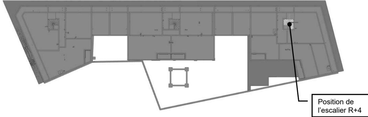
Nota : Les escaliers sont en **béton armé d'une masse volumique de 2 500 kg/m³**.
