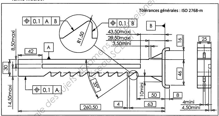
1.4- À partir des éléments de l'analyse fonctionnelle et du dessin d'ensemble de la chandelle en position haute et basse, **repérer (surligner, entourer) sur le document réponse DR1**, <u>en rouge</u>, les surfaces usinées que l'on doit retrouver sur la tige moulée.
