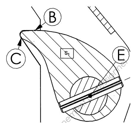
4.6- L'équivalent statique des actions en B et C étant modélisé en K par un glisseur de direction connue, **représenter** l'équilibre de la tige  $S_2$ , alors soumise à 3 glisseurs sachant que  $\vec{A}_{\text{Charge/tige}}$  est parfaitement connue.
