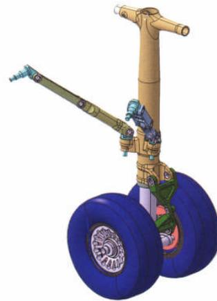
La BRANCHE DE COMPAS en aluminium (EN AW-7075) est matriçée sur une presse hydraulique de 10 000 Tonnes.
