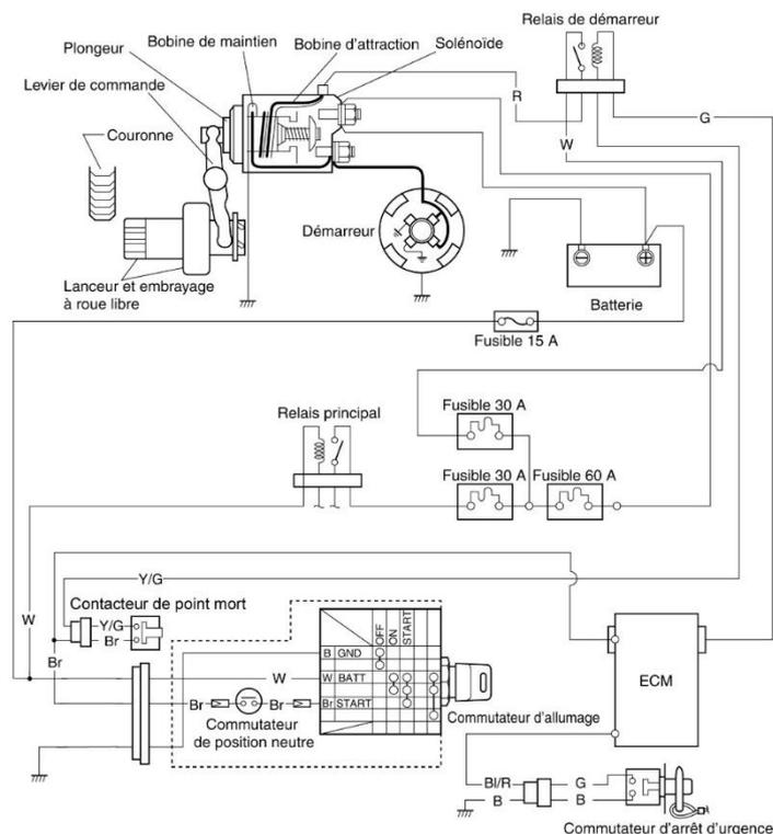
**Vérification du commutateur de démarrage sur la commande à distance par des mesures de continuité.**
