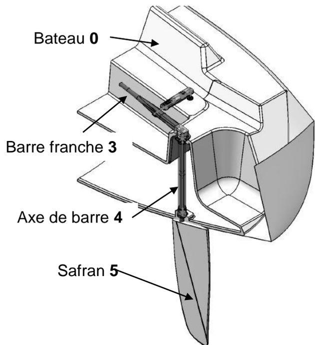
**5.1** Déterminer l'effort sur le safran à partir de la poussée maximale du pilote.
