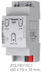
FANinBOX 110V 1CH Contrôleur pour ventilateur de plafond alimenté à 110 VAC (2 u de rail DIN). Il permet le contrôle de jusqu'à 3 vitesses de ventilation et le contrôle manuel des sorties avec indication d'état au moyen de LEDs. Il inclut un module de 10 fonctions logiques et un indicateur d'erreur de panne d'alimentation.
