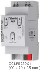
FANinBOX 230V 1CH Contrôleur pour ventilateur de plafond alimenté à 230 VAC (2 u de rail DIN). Il permet le contrôle de jusqu'à 3 vitesses de ventilation et le contrôle manuel des sorties avec indication d'état au moyen de LEDs. Il inclut un module de 10 fonctions logiques et un indicateur d'erreur de panne d'alimentation.
