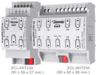
HeatingBOX 230V 8X - HeatingBOX 230V 4X Actionneur pour circuits d'eau climatisée qui permet le contrôle de jusqu'à 4/8 sorties pour vannes tout-ou-rien à 230VDC au moyen de triacs avec protection contre court-circuit. Il inclut un thermostat indépendant pour chaque sortie, en plus d'un module de 10 fonctions logiques. Il permet le contrôle manuel des sorties avec indication d'état au moyen de LEDs.
