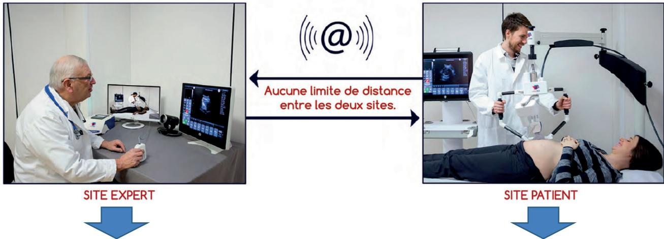
Un centre « expert » distant du lieu d'examen réel, avec un médecin « imageur » manipulant une « sonde fictive » similaire à une sonde réelle d'échographie, permet une prise de contrôle rapide et ergonomique à distance du robot.
