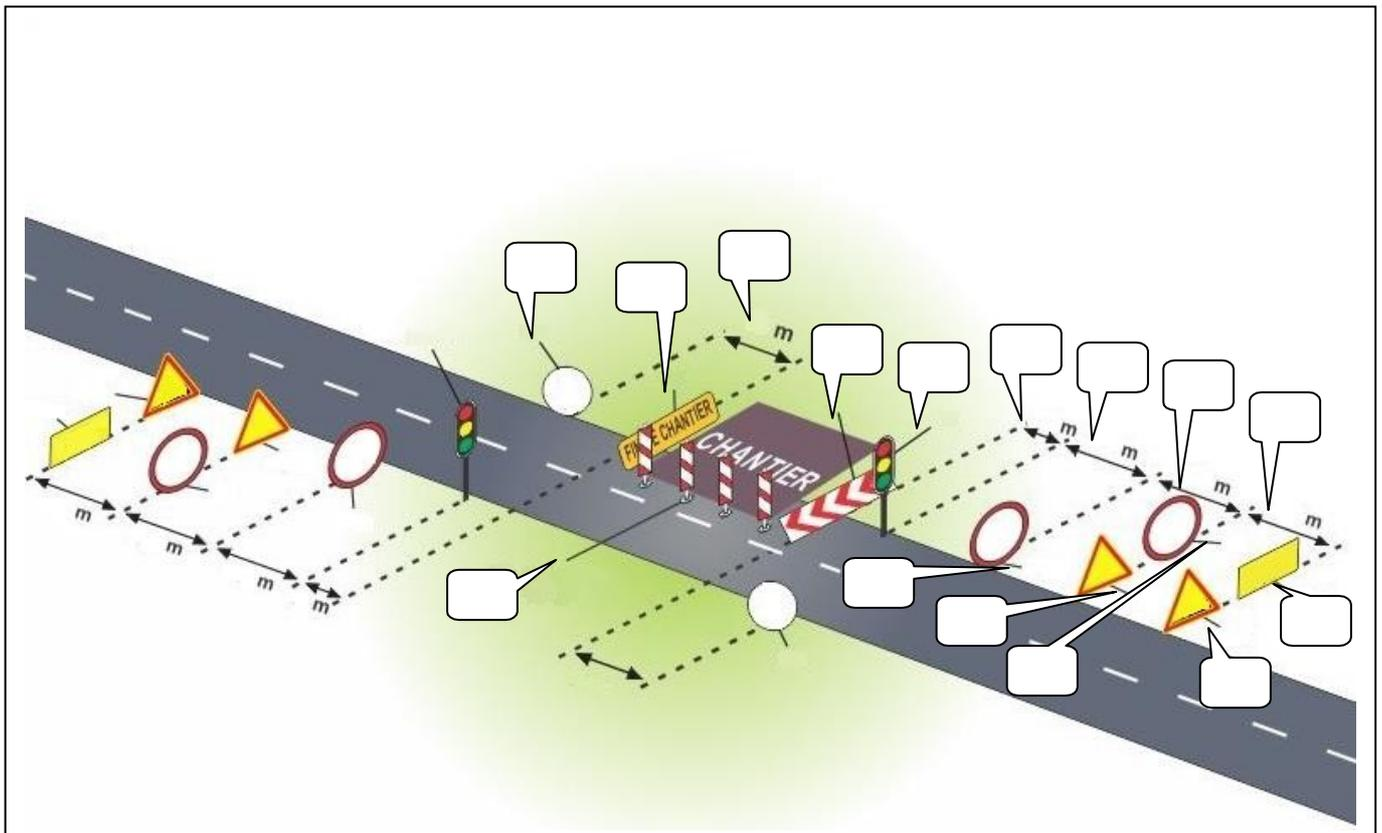
*Pour réaliser les travaux sur cette route communale, et limiter la vitesse (à 30 km/h) un arrêté de circulation doit être posé de part et d'autre du chantier.*
