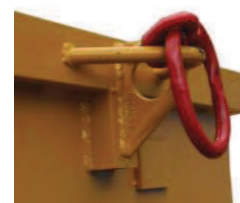
Système Détrompeur et connecteur+maille de tête
