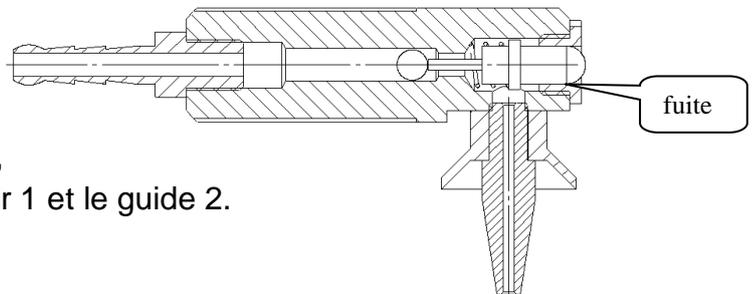
Indiquer quel type d'étanchéité doit être réalisé entre le poussoir 1 et le guide 2 en cochant les bonnes réponses dans le tableau ci-dessous (voir dossier ressources page DR14/16).
