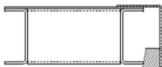
2 Cales (bois client) situées à proximité des axes
