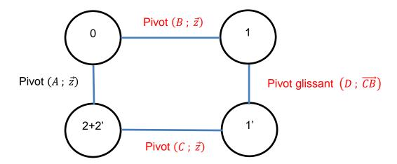
Question 5.2.2 | **Définir** le mouvement de l'ensemble {2 ; 2'} (bobines-pelle) par rapport au support  $\{0\}$ . En déduire la direction du vecteur vitesse  $\vec{v}_{(C:2/0)}$  de l'ensemble {2 ; 2'} (bobines-pelle) par rapport au support {0} au point C.
