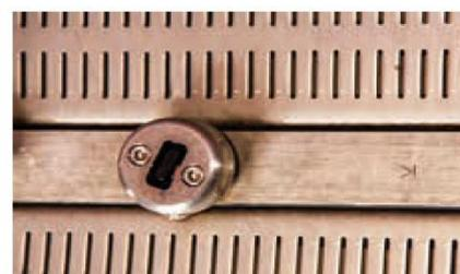
Buse d'injection d'anti-oxydant
