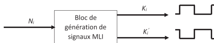
Figure 4 : génération des signaux de MLI pour les interrupteurs d'un bras
