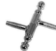
**Fiche à tourillon** : utilisée pour les menuiseries (fenêtre, porte...) à recouvrement, constituée de 2 parties (mâle et femelle) pas de sens d'ouverture. Possibilité de réglage sur 2 axes. Installation (usinage) par perçage de l'ouvrant et du dormant.
