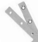
**Pivot** : Constitué de 2 parties (mâle et femelle) couramment employé par les ébénistes. Pas de sens d'ouverture. Installation (usinage) par entaillage de l'ouvrant et du dormant. Pour porte encastrée.
