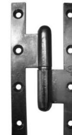
**Paumelle** : constituée de 2 parties (mâle et femelle) généralement employée pour les portes de communication. 2 sens d'ouvertures à déterminer suivant l'ouverture de la porte. Installation (usinage) par entaillage de l'ouvrant et du dormant. Pour porte encastrée.
