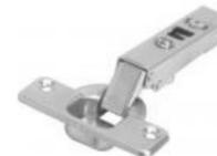
**Charnière à ressort** : utilisée par les agenceurs (cuisine, dressing) pour une porte à recouvrement total, partiel ou encastrée. Pas de sens d'ouverture. Possibilité de réglage sur 3 axes. Installation (usinage) par perçage de l'ouvrant et vissage sur le dormant.
