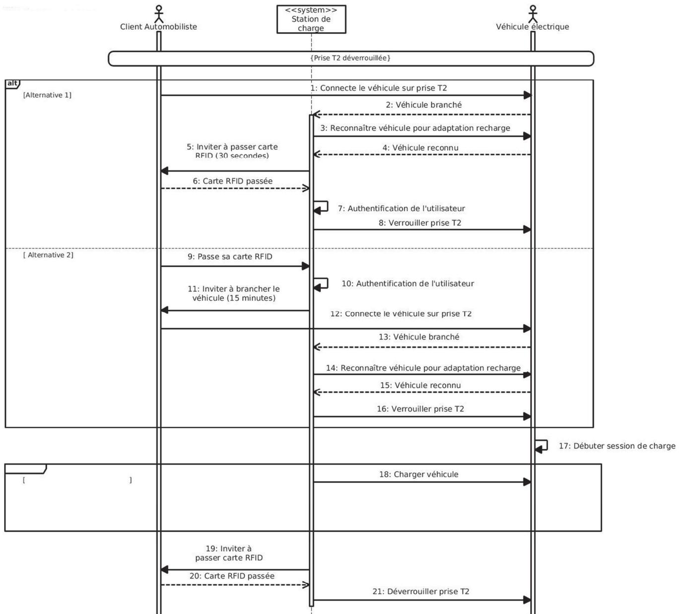
Figure 5 : diagramme de séquences système
