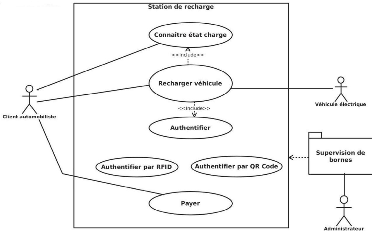
Figure 4 : diagramme de cas d'utilisation – Station de recharge
