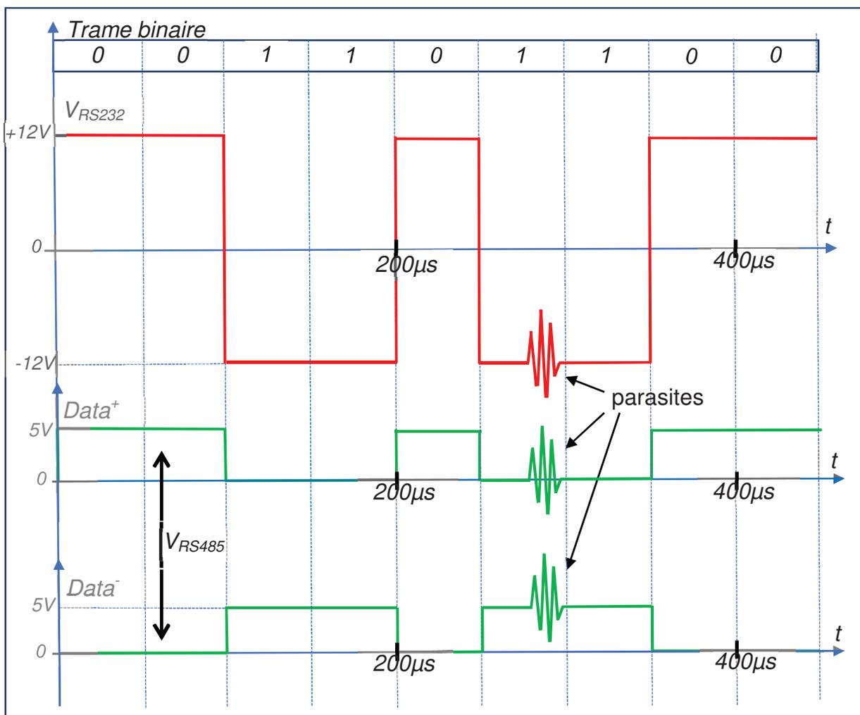
Figure 2 : exemple de chronogrammes de signaux pour une liaison de type RS-232 et RS-485
