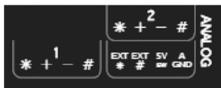
L'enregistreur DT82E possède **2 voies analogiques** (1 et 2) pour la mesure des courants. La valeur du courant est obtenue en mesurant la tension aux bornes d'une résistance shunt connue puis en appliquant la loi d'Ohm.
