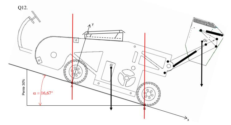
Les droites d'action en A et B sont verticales car la machine est à l'arrêt et les 4 roues sont motrices et freinées identiquement (cf. DT5)
