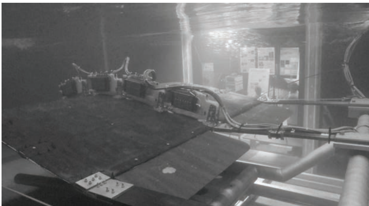
Hydrolienne à membrane en phase de tests en bassin - IFREMER de Boulogne sur mer
