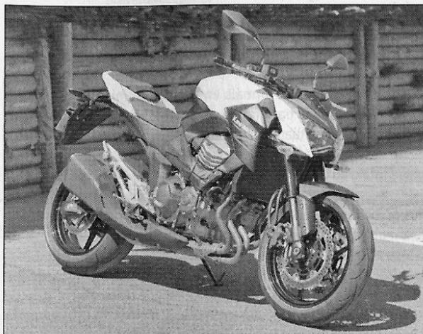
Seul un œil expert distinguera l'absence de sabot moteur et les étriers des freins avant à double piston, de la Z800e, lorsque, comme sur ce modèle, elle est dépourvue de l'ABS (Photo RMT).
