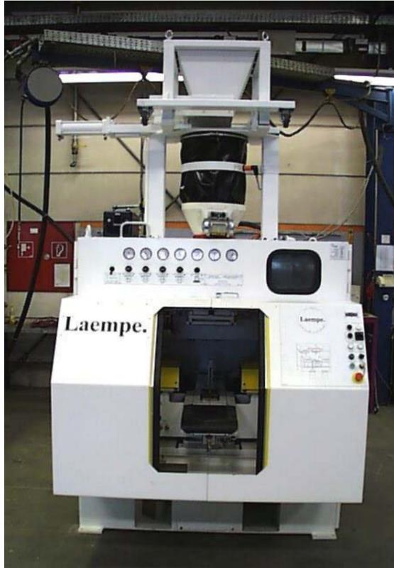
Figure 2 : Machine à noyauter de marque Laempe, série LL.
