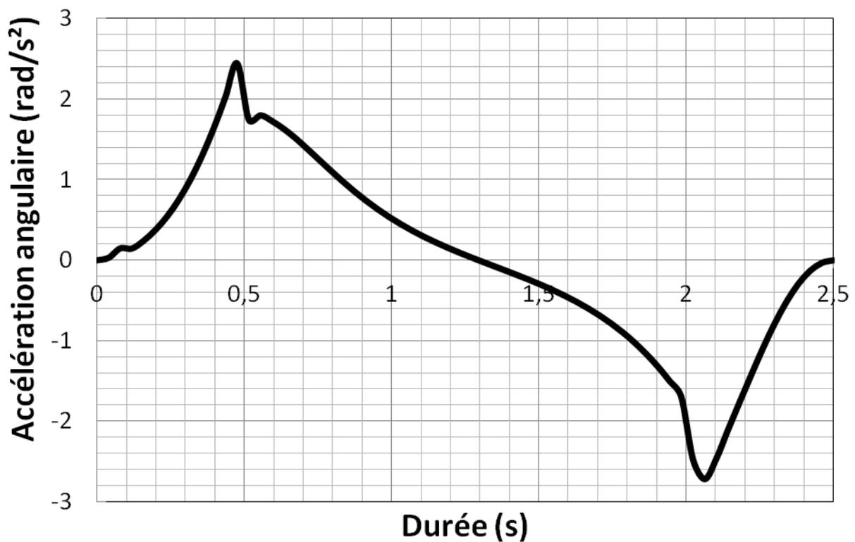
**Figure 2 :** évolution de l'accélération angulaire du magasin  $\gamma_{\text{magasin/bâti}}(t)$  pendant la phase de montée
