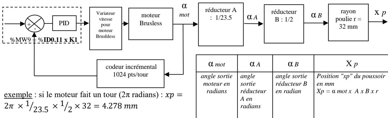
exemple : si le moteur fait un tour ( $2\pi$  radians) :  $x_p = 2\pi \times \frac{1}{23.5} \times \frac{1}{2} \times 32 = 4.278 \text{ mm}$
