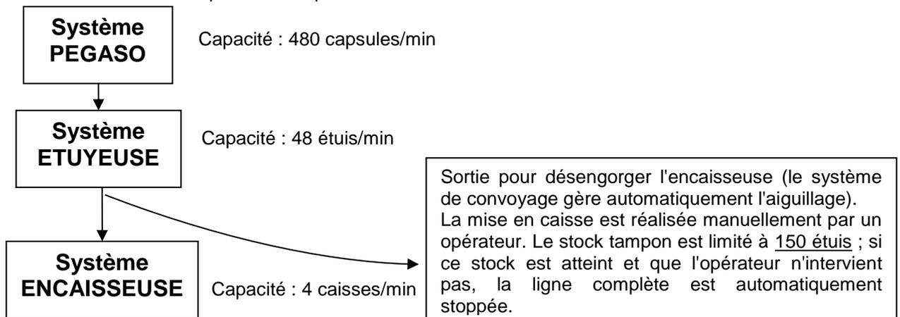
**C3-1 - Calculer la durée maximale pendant laquelle l'opérateur ne peut pas intervenir pour réaliser manuellement l'encaissage sans l'arrêt automatique de la ligne :**
