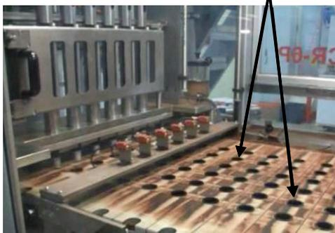
Déchargement des capsules sur convoyeur
