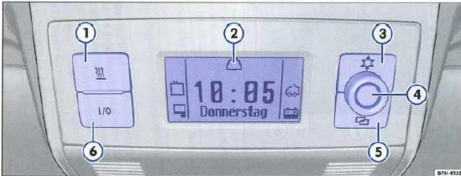
Fig. 6 Dans le ciel de pavillon : éléments de commande de l'unité de commande centrale avec affichage d'accueil
