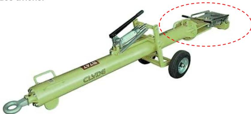
L'extrémité est composée de pièces modulables en fonction des différents trains d'atterrissage.
