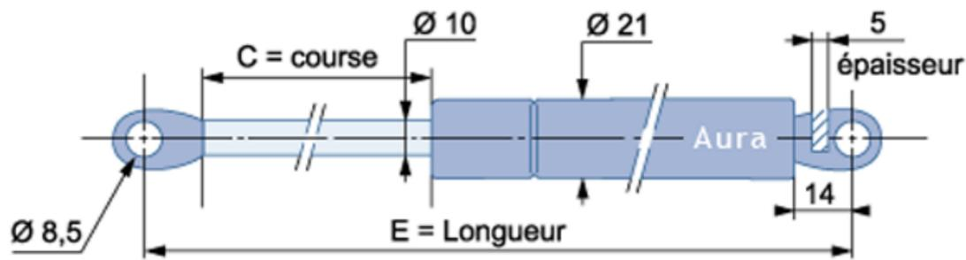
Vérin de POUSSÉE avec chape à œil soudée - tige Ø10 mm - corps Ø21 mm
