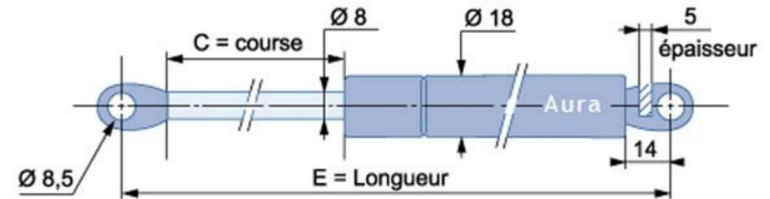
Vérin de POUSSÉE avec chape à œil soudée - tige Ø8 mm - corps Ø18 mm
